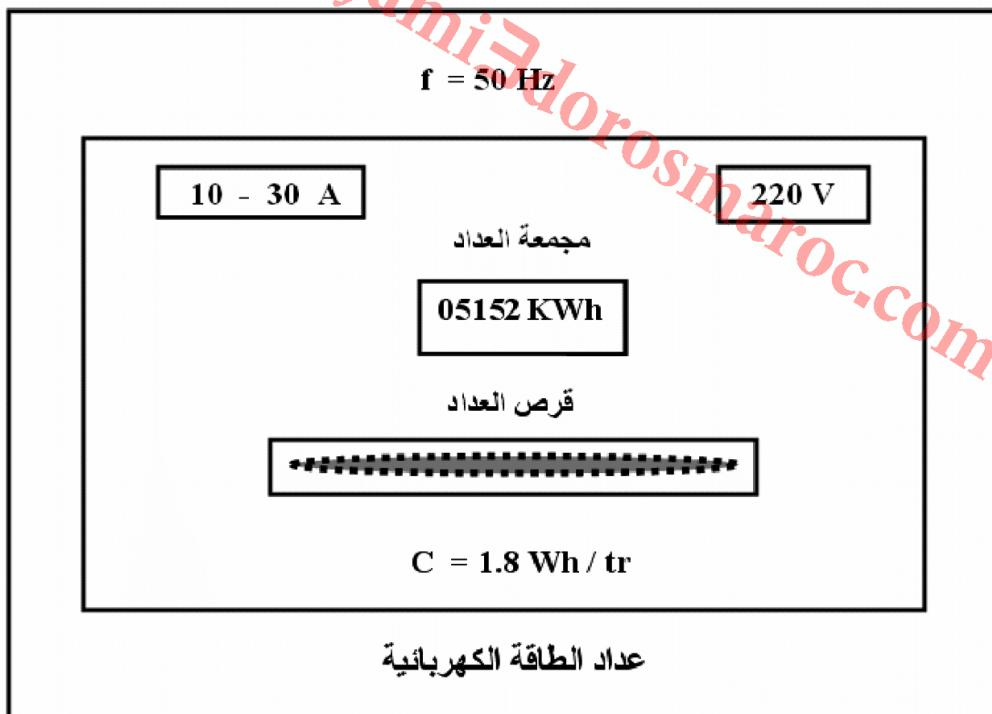
2- تحديد الطاقة الكهربائية المستهلكة باستعمال عداد الطاقة الكهربائية :
